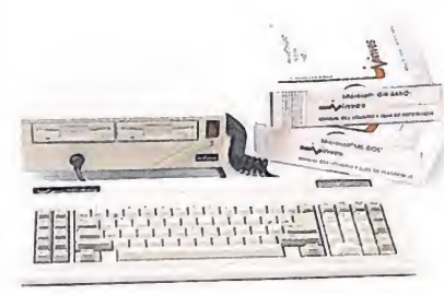
CPU con 2 unidades de diskette 3 1/2" (720 Kb). Con teclado y sistema operativo MS-DOS 3.2 y GW BASIC 3.2.
